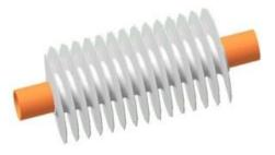
Теплообменные трубы производятся без определенного защитного покрытия толщиной до 6 м. Для тропиков трубы делают с анодно-окисным защитным покрытием (длина до 2,5 м). Масса одного метра трубы составляет 1,4 кг, а рабочее давление - 0,6 МПа
