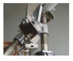
Штанговые заземления серии У категории 1.1, в соответствии с «Инструкцией», используются в открытых и закрытых электрических установках, воздушных линиях электропередач. Переносное заземление используется для эксплуатации в сухую погоду. Если имеют место атмосферные осадки, изморозь, то пользоваться данными устройствами запрещается.
